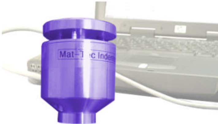
Fig. 4: Mobiler Indentor Mat-Tec Unihard mit Belastungskopf für manuelle Belastung
